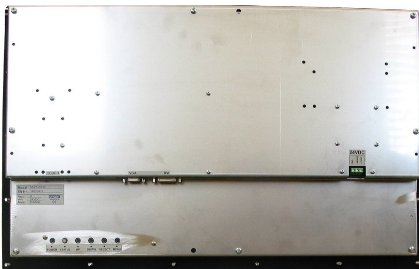
Rückseite Monitor mit Standardfrontplatte und Montagebolzen
