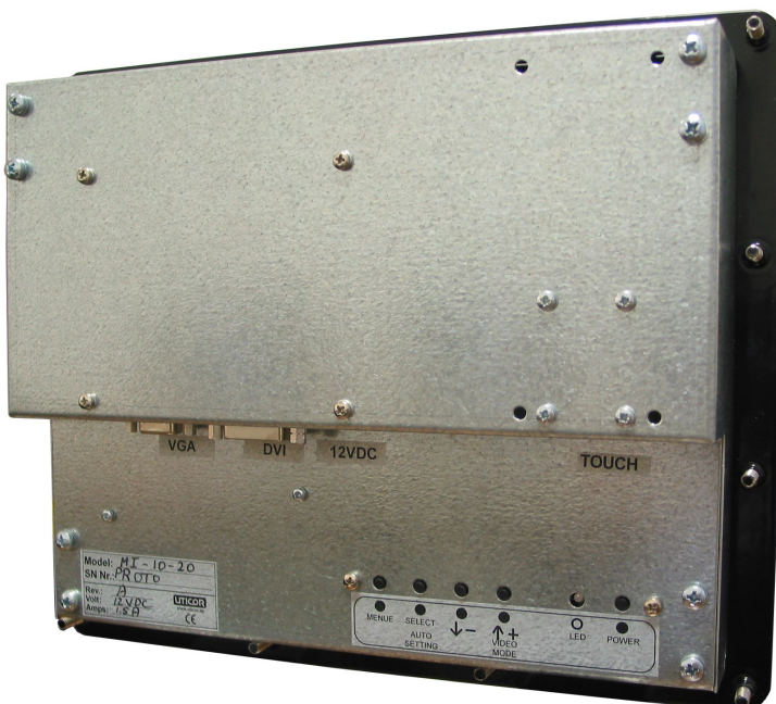
Rückseite Monitor mit Standardfrontplatte und Montagebolzen
